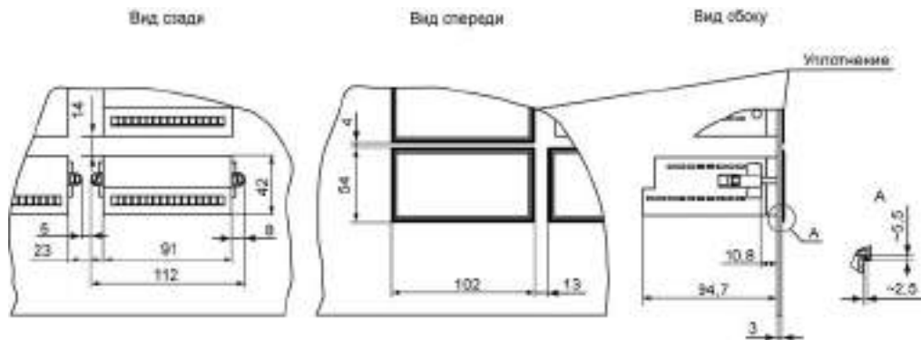
Рисунок А.6 - Прибор в корпусе Щ2, установленный в щит толщиной 3 мм
